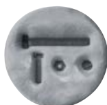
Preparazione in loco di piccoli stampi per impronta
