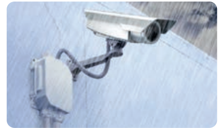
Installazione con cavi liberi.
