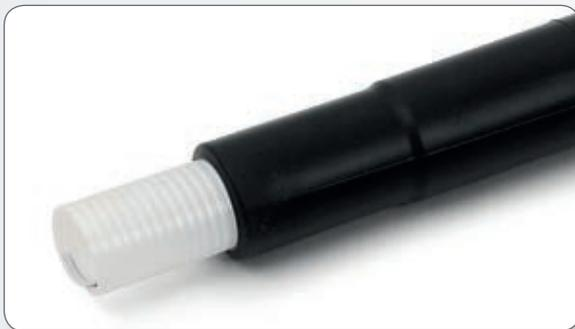
Raytech a mis au point, dans ses laboratoires et avec ses propres lignes de production, un support en spirale au profil sophistiqué, sur lequel dilater la jonction: le support, extrudé sur les filières Raytech, formé au diamètre d'application sur les lignes de conditionnement dédiées et automatisées, est chaussé dans le corps de la jonction.
