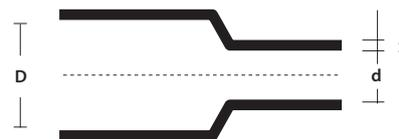
**D** = Ø diamètre minimal avant le rétrécissement
