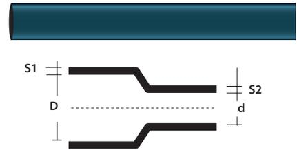
D = Ø diamètre minimal avant le rétrécissement
