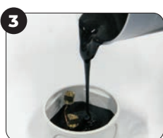
3 Verser le produit dans l'étui à remplir.
