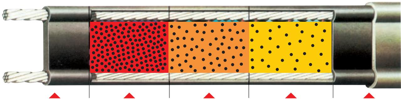
Las partículas de grafito constituyen muchas conexiones en paralelo entre los dos conductores de cobre.
