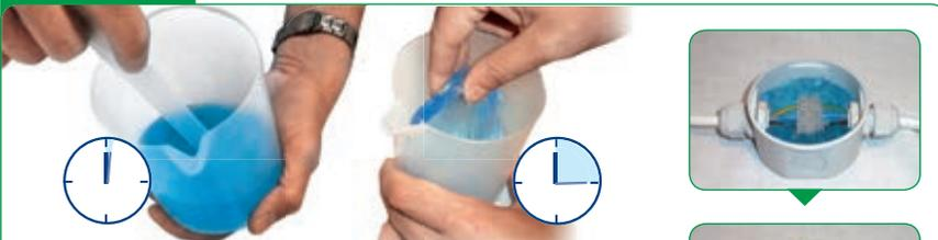
Verter los componentes en el medidor, mezclar y dejar reticular (unos 15 minutos). Retirar el producto aislante, y aplicarlo en pequeñas partes alrededor de la conexión de modo que esta quede completamente recubierta. Naturalmente el producto aislante puede ser conservado con mezclas precedentes.
