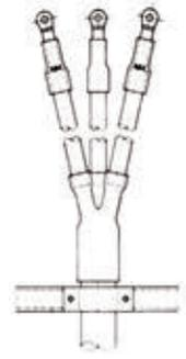
Comprenden la funda para recubrir las fases, el sellado del punto de apertura de las fases y el sellado entre fase y terminal del cable.
