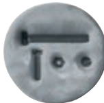
Preparación en el sitio de pequeño moldes para impresión
