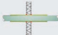
Rohr ohne Isolierung
