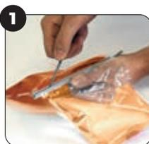
**1** Abscheider aus dem Beutel Rayresin entfernen.
